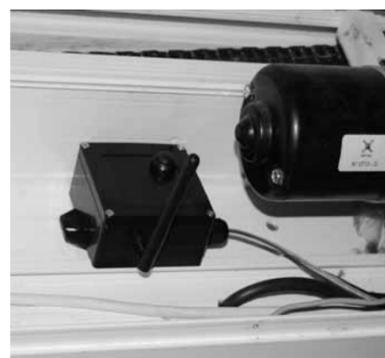
**7.6** Placer le récepteur après le moteur d'élévation de l'abri, et orienter l'antenne verticalement.
