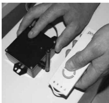
**7.5** Appuyez sur le bouton du récepteur, jusqu'à ce que le voyant s'allume, puis sur un bouton de la télécommande. Lorsque le voyant clignote la mise en service est effectuée.
