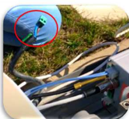
Branchement de la prise d'alimentation (depuis le kit secteur ou depuis le panneau solaire). D'un seul côté de l'abri.
