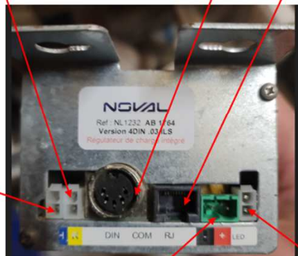
Branchement de la prise d'alimentation (depuis le kit secteur ou depuis le panneau solaire). D'un seul côté de l'abri.
